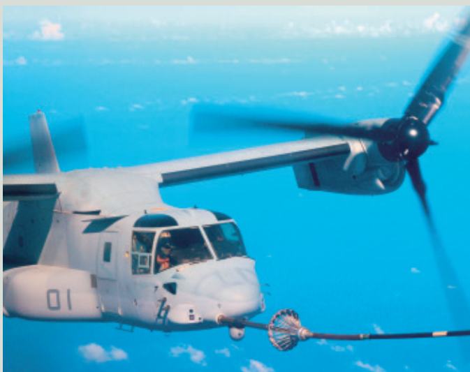
空中給油を行うMV22オスプレイ(米海兵隊ウェブサイトに)
